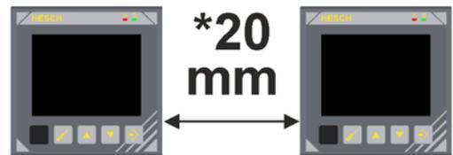
1. Ausschnitt (92 × 92 mm +0,8mm Toleranz) in die Schaltschranktür oder das Bedienpult schneiden.
