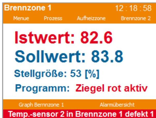
Abbildung 62 Beispiel Bedienseite mit Bedienmenü oben und Alarmtext
