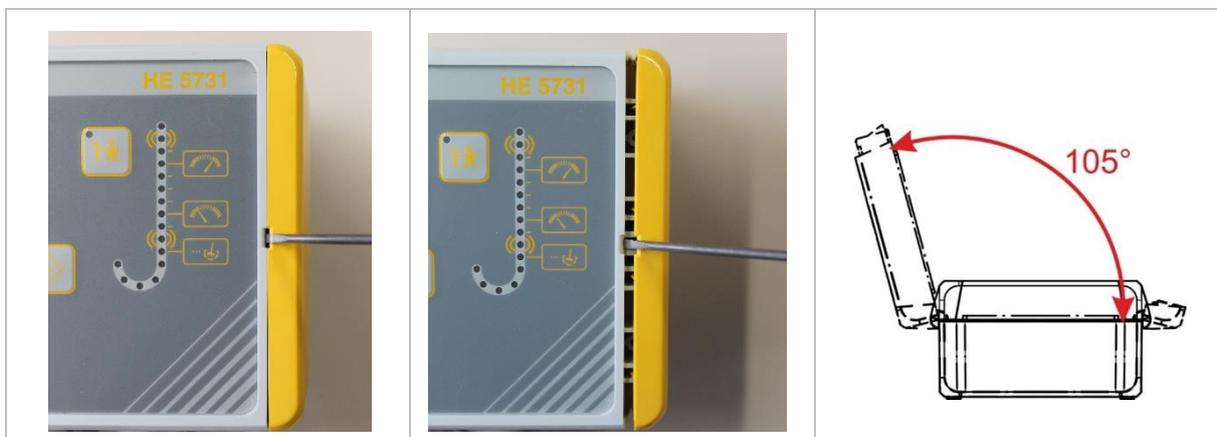
Abbildung 2. Gehäusedeckel nach links öffnen (*zeigt ein vergleichbares Modell*)
