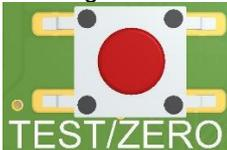
2. Das lange Drücken der Taste setzt den durch die Nullung berücksichtigten Offset auf 0 mbar zurück.
