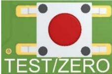
1. Durch einen Doppel-Klick der Taste, wird der aktuell an den Druckanschlüssen anliegende Druck als 0 mbar angenommen (AUTO ZERO). Voraussetzung für eine erfolgreiche Nullung ist, dass sich der gemessene Druck im Bereich  $\pm 10\%$  vom Sensor-Messbereich um den Nullpunkt befindet.
