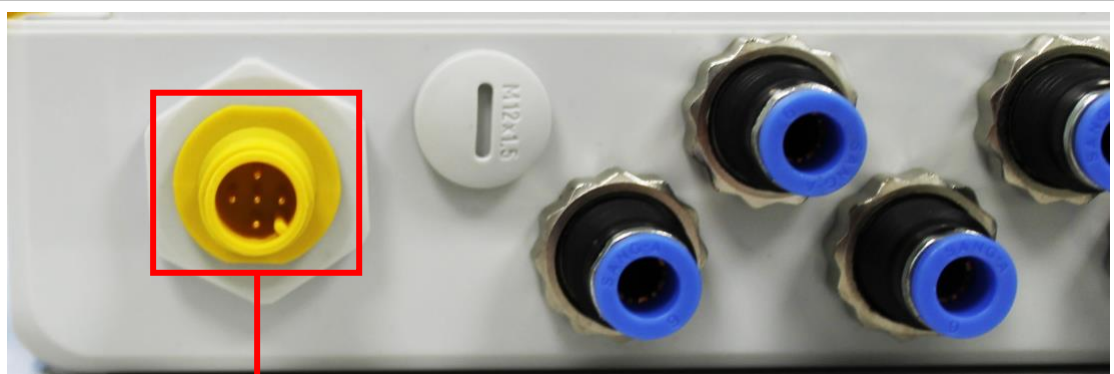
M12-Steckverbinder, 5-polig, A-kodiert
