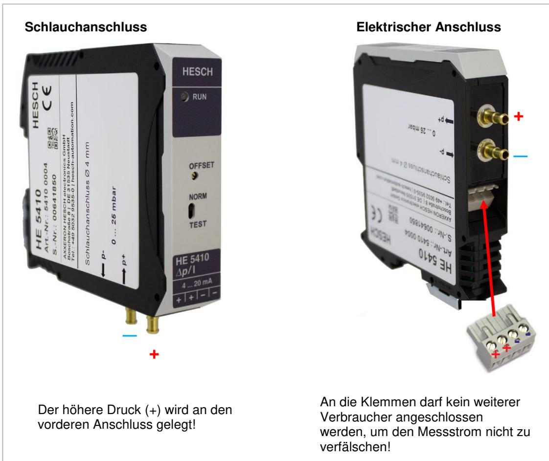
Abbildung 3. Anschlüsse (pneumatisch und elektrisch)
