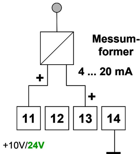
Anschluss eines 2 –Draht Messumformers mit 24 V Versorgung, 4 – 20 mA Ausgang.
