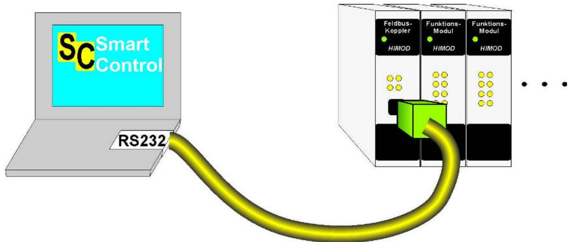
Abb. 15 Anschluss 'SmartControl'
