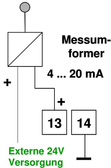
Anschluss eines 2 –Draht Messumformers mit 24 V Versorgung, 4 – 20 mA Ausgang.
