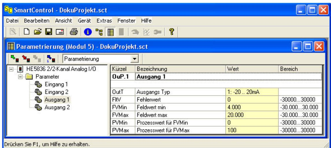
Abb.14 Bildschirm Parametrierung Modulfunktion - Ausgänge
