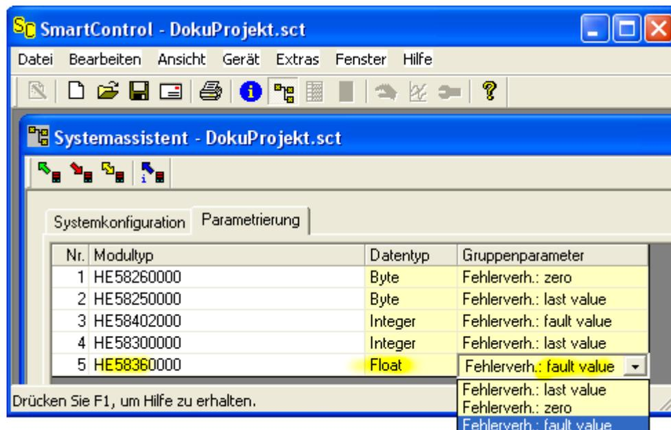
Abb. 16 Bildschirm Parametrierung Datentyp, Fehlerverhalten
