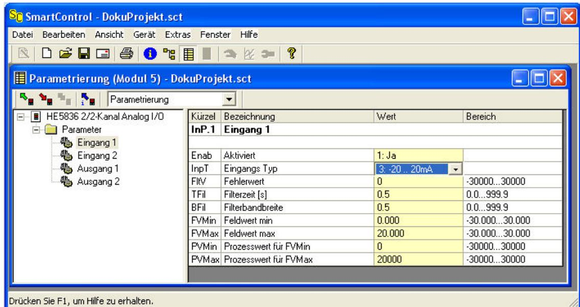
Abb. 8 Bildschirm Parametrierung Modulfunktion - Eingänge
