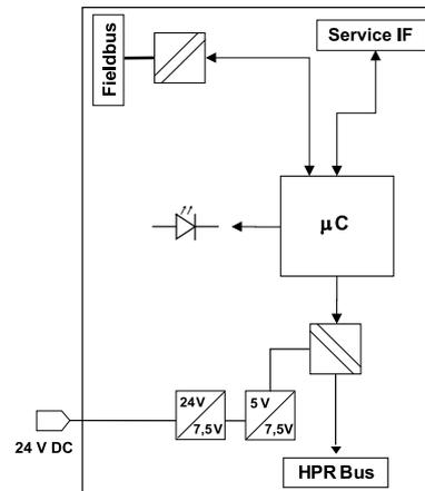
Der Feldbuskoppler HE 5812 verbindet das modulare Prozess-I/O HIMOD-System mit einem Profibus-DP-Netzwerk. Die Verbindung zu dem Profibus-DP wird über eine 9-polige D-SUB Buchse hergestellt. Es können bis zu 62 I/O-Module je Buskoppler angebunden werden. Die Anbindung der Module erfolgt über ein internes Bussystem. Bis zu 16 Module können direkt am Buskoppler betrieben werden, darüber hinaus kann das System durch ein zusätzliches Powermodul HE 5850 erweitert werden. Im Buskoppler werden
