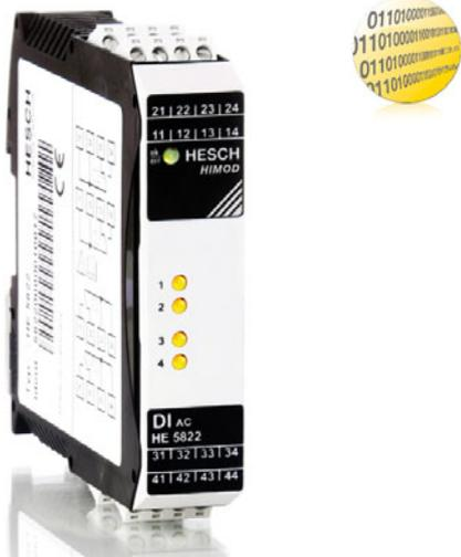
Das digitale Eingangsmodul HE 5822 erfasst bis zu vier binäre Signale von der Prozessebene und überträgt diese zum übergeordneten Bussystem. Die Kommunikation mit dem Feldbuskoppler erfolgt über eine asynchrone serielle RS485-Verbindung. Im Servicefall kann das Modul schnell und unkompliziert im laufenden Betrieb ausgetauscht werden (Hot Swap). Die Module akzeptieren 115 V AC (US) und 230 V AC (Europa) Eingangsspannung. Der Signalzustand der digitalen Eingänge wird über Status-LEDs
