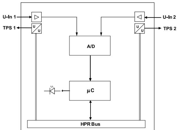
Das analoge Eingangsmodul HE 5831 erfasst bis zu zwei analoge Signale von Weg-, Winkel- und Positionssensoren und überträgt diese zum übergeordneten Bussystem. Die Kommunikation mit dem Buskoppler erfolgt über eine asynchrone serielle RS485-Verbindung. Zur Versorgung der potentiometrischen Geber wird eine kurzschlussfeste Spannung zur Verfügung gestellt. Jeder Eingang hat einstellbare MIN- und MAX-Werte, bei denen eine Alarmmeldung an die prozessführende Steuerung gemeldet wird. Die
