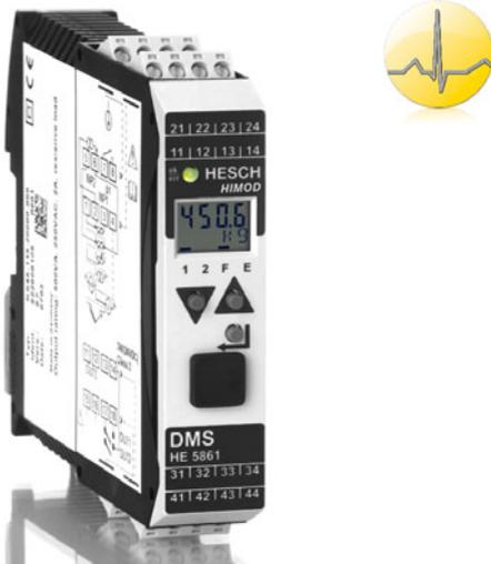
Das DMS-Modul HE 5861 erfasst den Messwert von Wägezellen, DMS oder von Massedruckensoren. Im Servicefall kann das Modul schnell und unkompliziert im laufenden Betrieb ausgetauscht werden (Hot Swap). Die Prozesswerte werden über eine LCD-Anzeige dargestellt. Dehnungsmessstreifen (DMS) werden mit einer Auflösung von 23 Bit ausgewertet. Es stehen ein analoger Universalausgang (14 Bit) mit parallelem Strom- und Spannungssignal und zwei Relais zur Grenzwertüberwachung zur Verfü-
